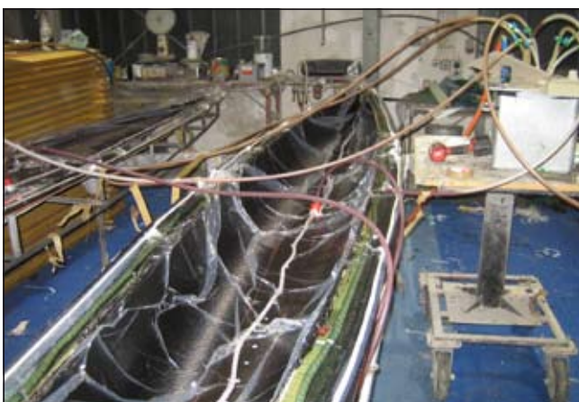
Slika 5. Vakuumska infuzija glavnega trupa
