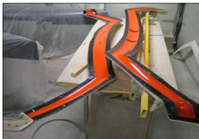
Slika 6. Priprava kalupov za prečko
