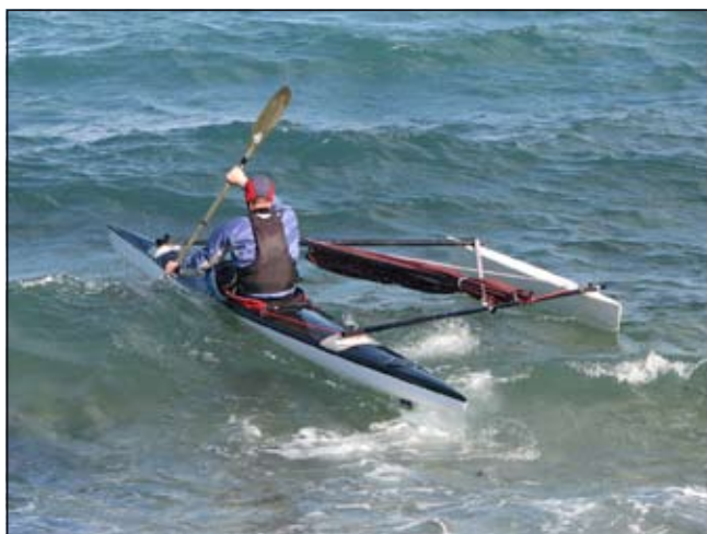
Slika 1. Katamaranska prototipna izvedba jadralnega kajaka
